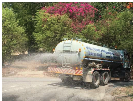
รูปที่ 2-14: การฉีดพรมน้ำบริเวณหน้าเหมืองและเส้นทางลำเลียงแร่
